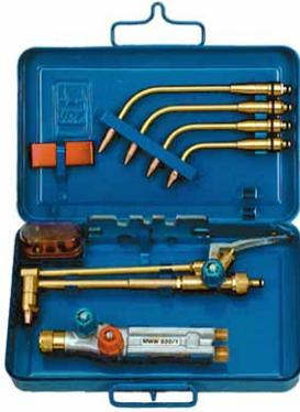
Geeignet zum Schweißen (nur für Brenngas Acetylen), Schneiden, Wärmen, Flammlöten und Flammrichten in kleinen Arbeitsbereichen.
