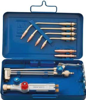
Geeignet zum Schweißen (nur für Brenngas Acetylen), Schneiden, Wärmen, Flammlöten und Flammrichten in kleinen Arbeitsbereichen.
